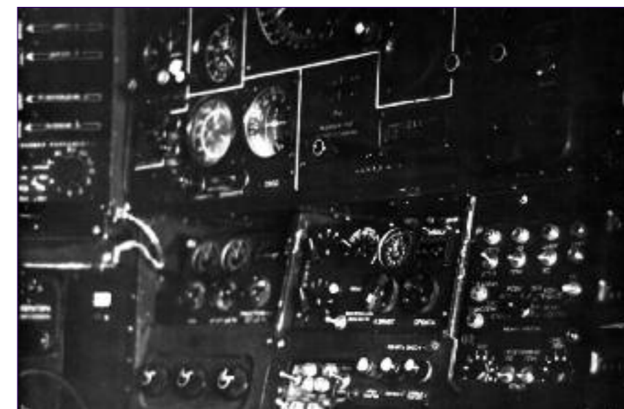
Часть приборной доски на рабочем месте штурмана
