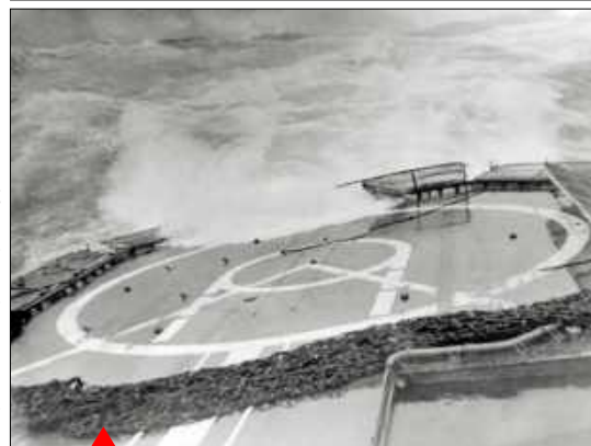
Снимок вертолётной площадки сделан из СКВП. Морская стихия разрушила ограждение площадки, разорваны сети для обеспечения взлёта и посадки вертолёт, ют корабля более двух метров под водой.
